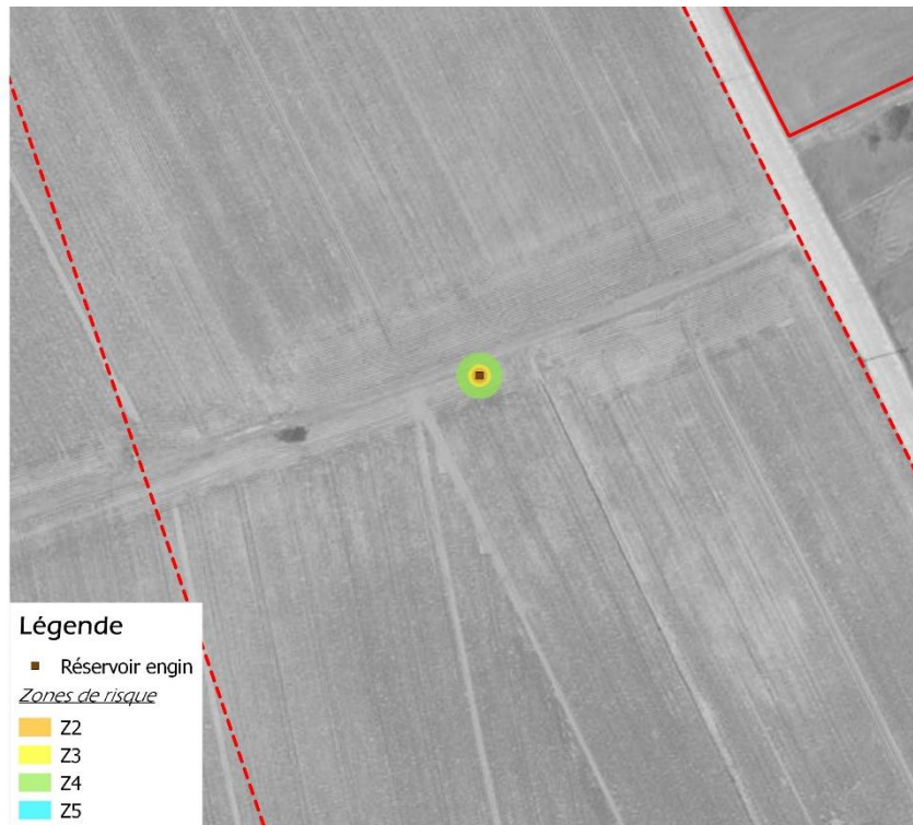
Explosion – zones de risques significatifs – cas d'un réservoir d'engin
