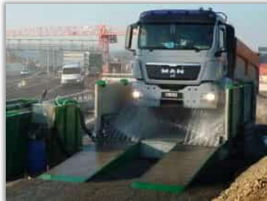
Nettoyeurs décrotteurs fixes à jets d'eau ou à grille
