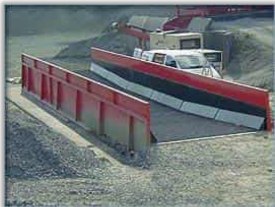
Nettoyeurs décrotteurs fixes à jets d'eau ou à grille
