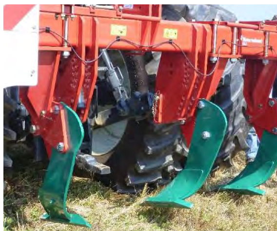
Figure n° 5 : Exemple de matériels de sous-solage attelés montrant des dents incurvées (photo de gauche) ou obliques (photo de droite).
