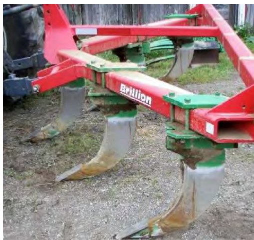
Figure n° 5 : Exemple de matériels de sous-solage attelés montrant des dents incurvées (photo de gauche) ou obliques (photo de droite).
