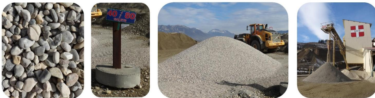
La carrière dispose de différents stocks de granulats de coupures différentes afin de faciliter le chargement des camions des clients.
