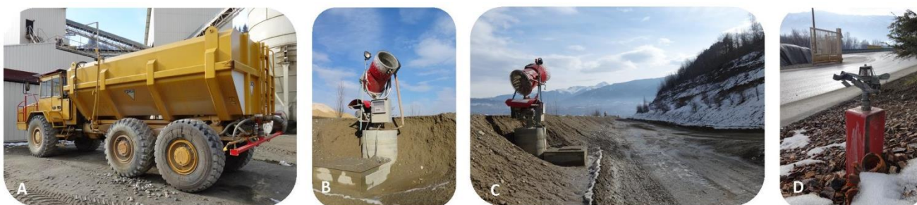
Illustrations de différents dispositifs d'arrosage présents sur le site de Barraux, permettant de réduire au maximum les émissions de poussières. De gauche à droite : (A) Camion citerne à eau équipé d'un système d'arrosage (à l'arrière de l'engin) ; (B) et (C) Quatre canons à neige aspergent notamment la piste principalement utilisée par les tombereaux ; (D) Dispositif d'arrosage situé à proximité de la carrière. Photo : 2015 - Granulats VICAT.
