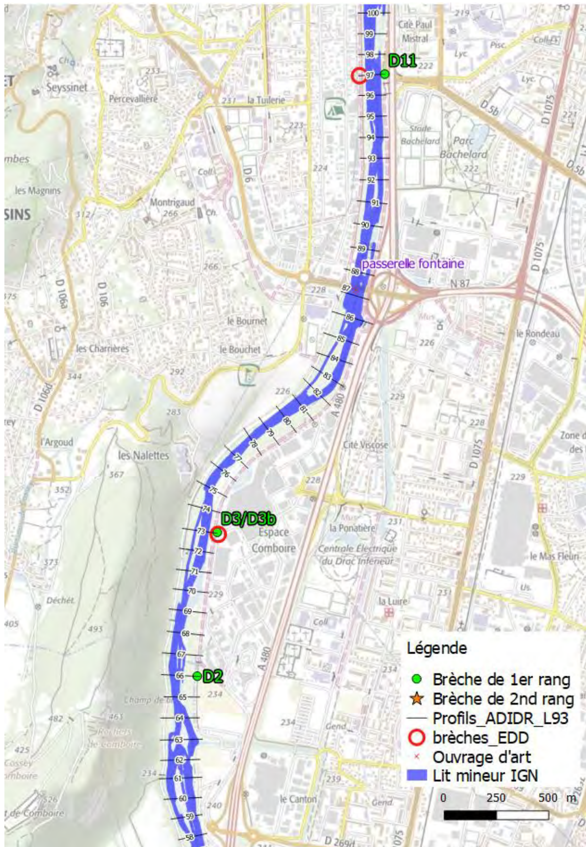
Figure 108 : Pré-positionnement des brèches – Part 2
