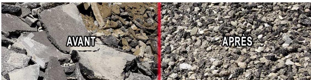
Recyclage des déchets du BTP dans la carrière de Morestel (source : site internet de l'entreprise)
