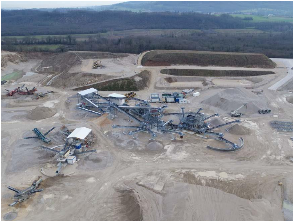
exemple d'installation de traitement des matériaux : nouvelle installation de la carrière de Palenge à ARANDON (source : cliché de l'entreprise)
