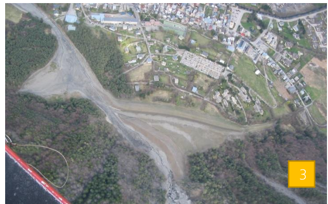
Construction des ouvrages de protection (1999-2001) : merlon pare-bloc (1), merlon pare-bloc et digue torrentielle/avalanche (2). Etat après construction (3) et en 2018 (4)
