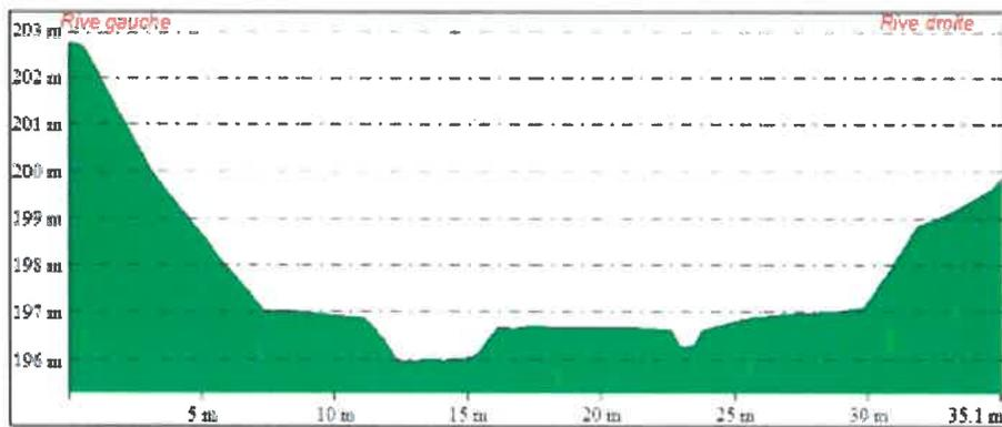
Figure 10 : Profil en travers de la plage de dépôt (cotes altimétriques arbitraires)
