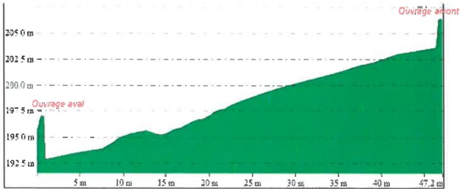
Figure 9 : Profil en long de la plage de dépôt (cotes altimétriques arbitraires)
