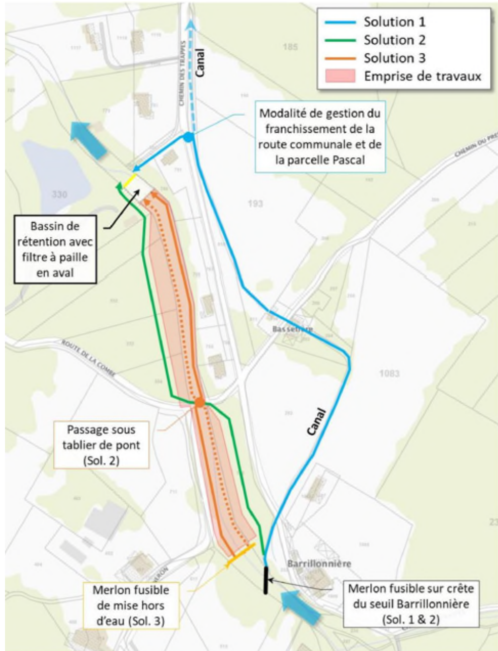
Fig 3 Dérivation provisoire pendant le chantier
