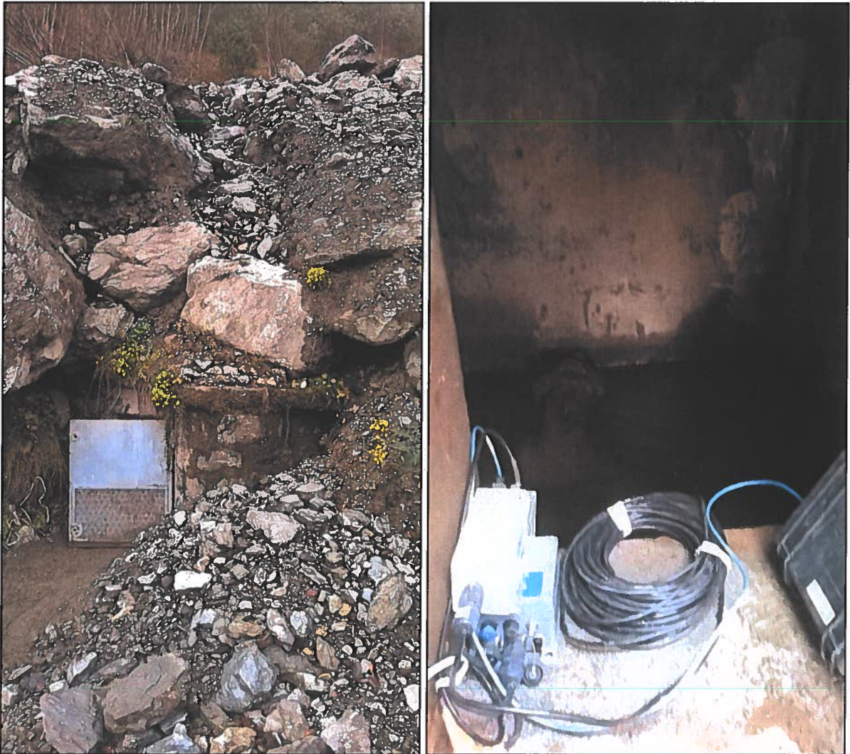
Sonde de conductivité au captage des Peyrouses
