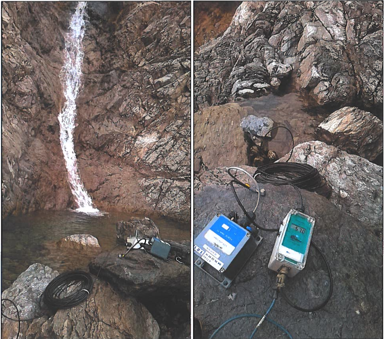
Sonde de conductivité à la cascade de la Pisse
