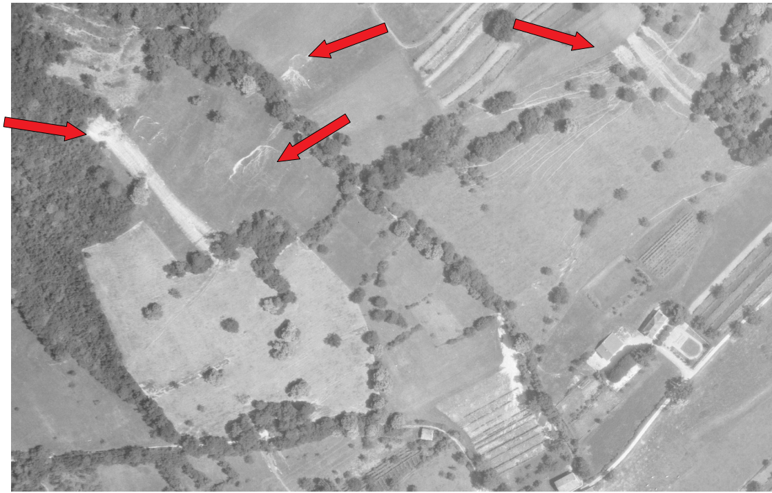
Illustration 41 : Glissements et coulées de boue sur le versant dominant le quartier de l'Agnelas, juin 1957 - Photographie aérienne juillet 1957
