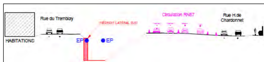
Figure 325 : Construction du piédroit sud à l'abri d'une paroi de soutènement
