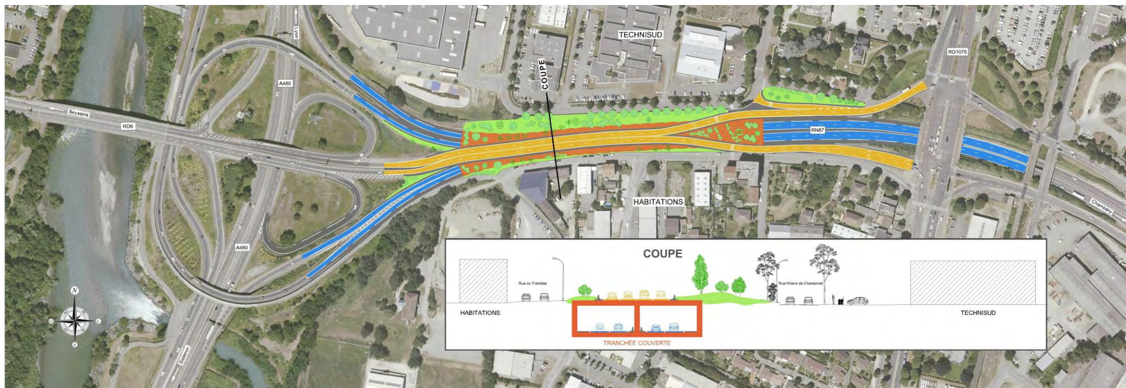
Figure 249 : Scénario « Tranchée couverte »
