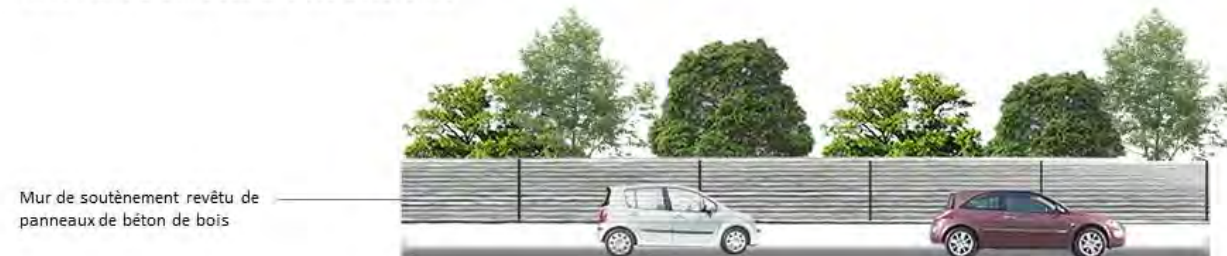
Figure 386 : Traitement architectural des murs de soutènement (© Ingerop)
