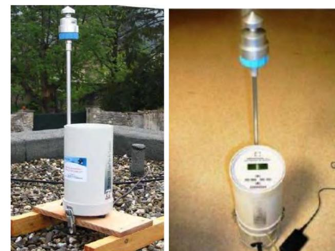
Figure 84 : Préleveur sur filtre (sources : Egis / ATMO Auvergne Rhône-Alpes / Eco Mesure)
