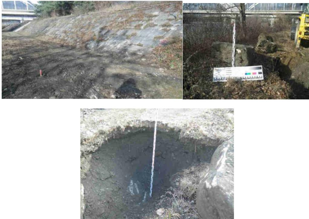
Figure 66 : Photo des sondages à la pelle au niveau de la digue
