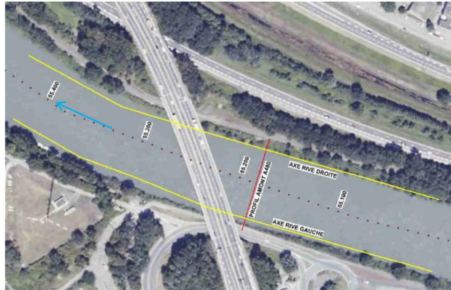
Figure 58 : Situation des axes des profils en long des rives gauche et droite
