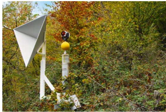
Ruines de Séchilienne : cibles de visée permettant d'effectuer des mesures radar (trièdre blanc) et géodésiques (prime rouge)
