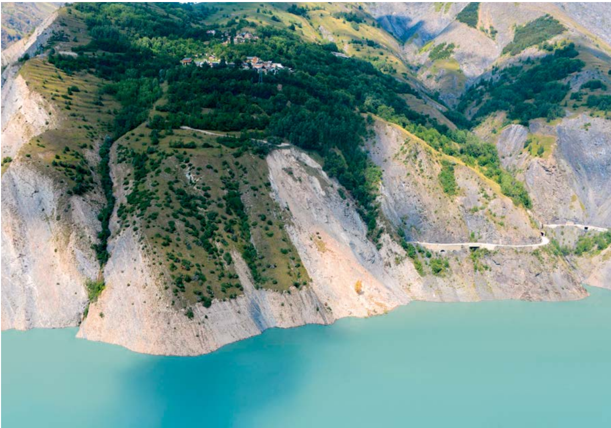
Un grand glissement de terrain (environ 600 000 m 3 de schistes) a entraîné la fermeture totale à la circulation du grand tunnel du Chambon reliant Grenoble et Briançon par la vallée de la Romanche - 10 avril 2015
