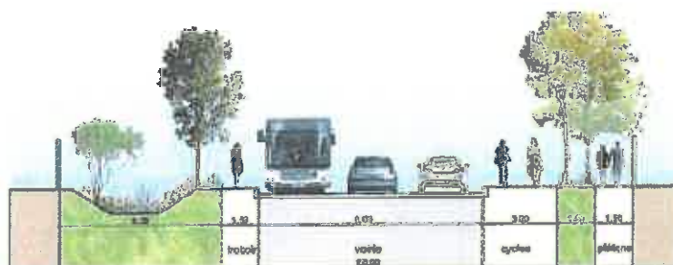
Profil type à l'approche du carrefour avec la RD1085
